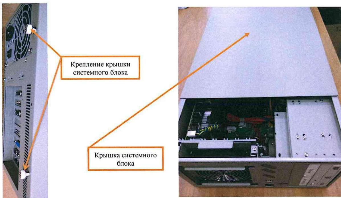
Рисунок 3. Вид системного блока со снятой крышкой.
