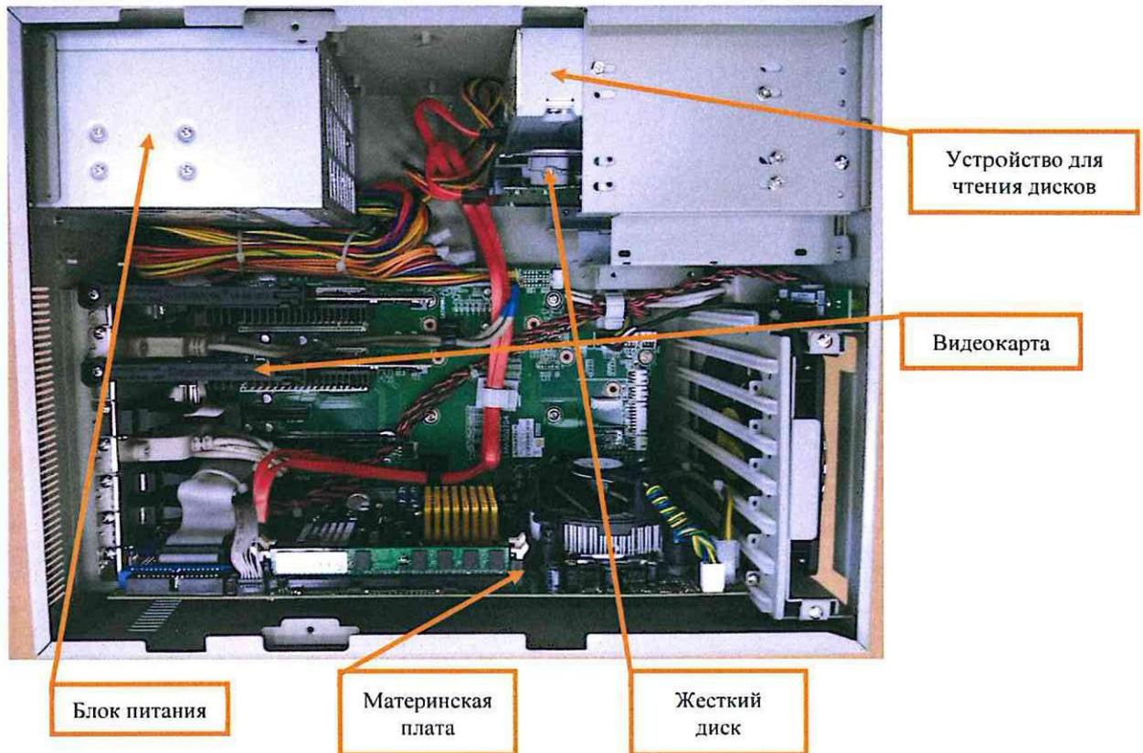
Рисунок 4. Основные элементы системного блока.
