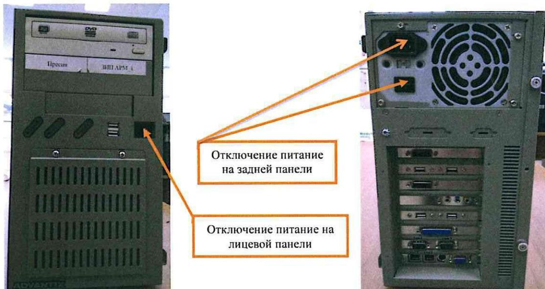
Рисунок 2. Отключение питания системного блока.
