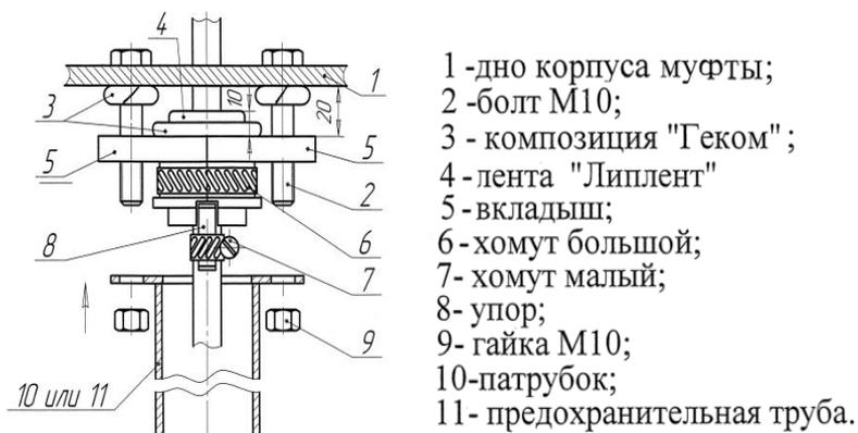
Рис.3. Состав герметизирующего комплекта
