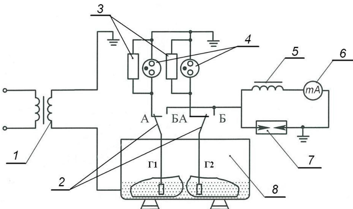
Рисунок 1 – Принципиальная схема испытания диэлектрических галош
