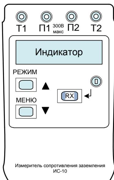
Рисунок 1. Расположение органов управления и гнезд подключения
