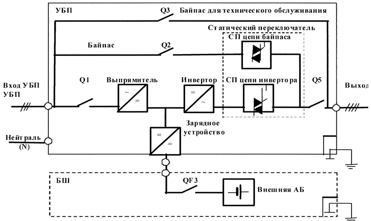
Рис. 4. Функциональная схема шкафа УБП (40 кВА и 60 кВА)
