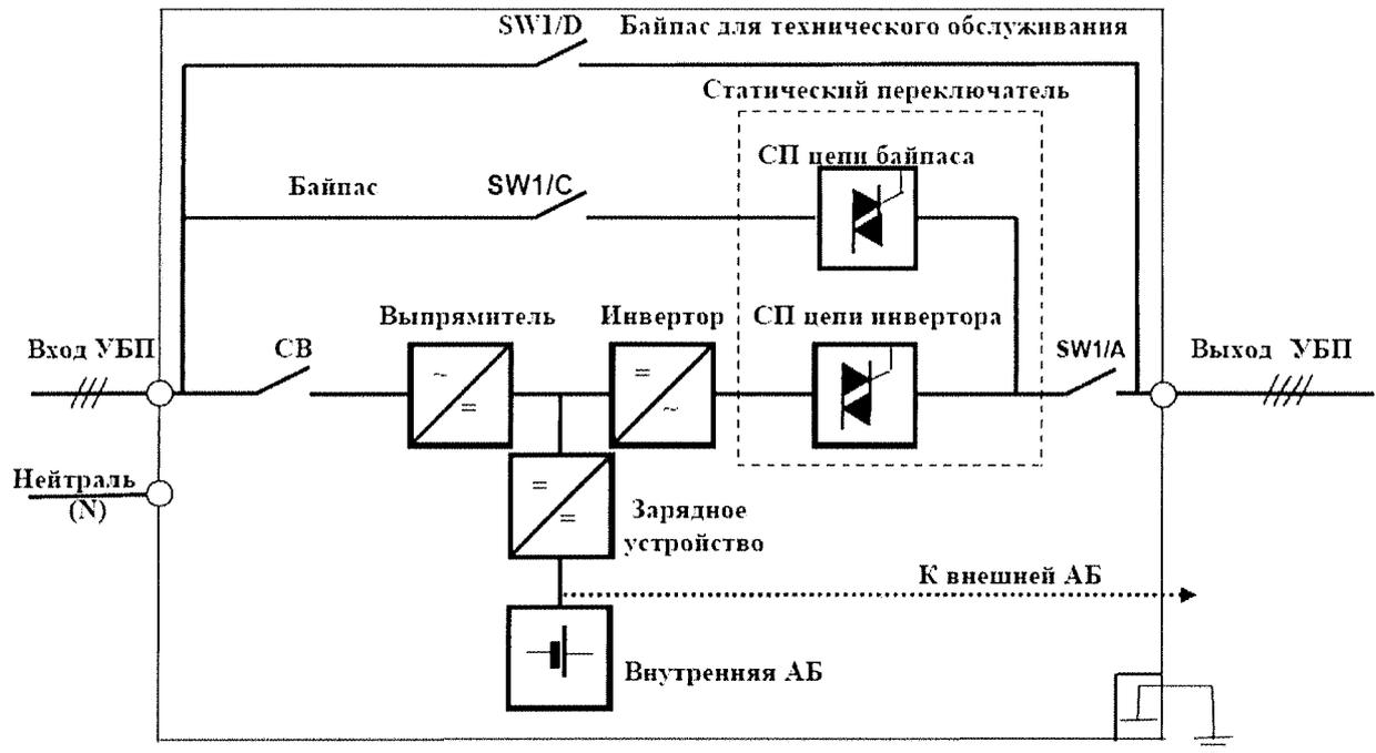
Рис. 3. Функциональная схема шкафа УБП (10 кВА и 30 кВА)
