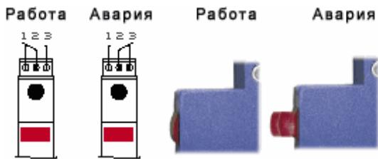
Примечание. При проверках следует обратить внимание на состояние сигнальных флагов на ограничителях перенапряжения FV в РЩ и ТЩ, вытянутое положение которых указывает на необходимость замены прибора (см. рисунок).
